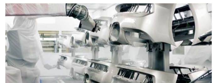
ABB-Roboter lackieren bei BMW Kunststoff-Stoßfänger. Quelle: ABB
