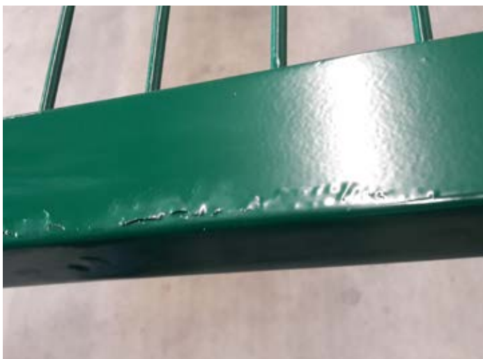
Abbildung 10: Zinkablösung nach der Beschichtung
