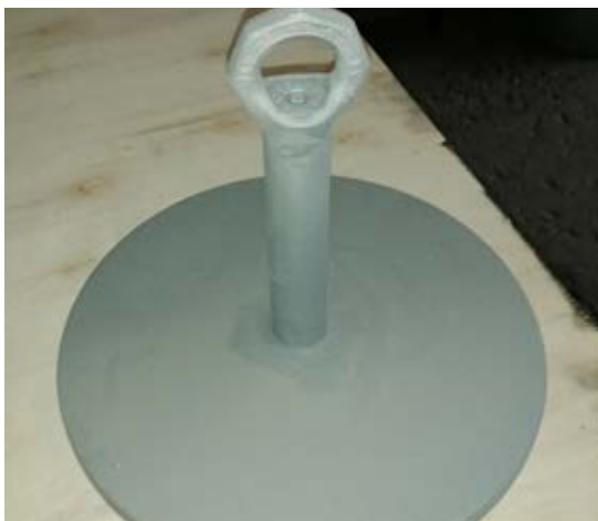
Kantig mit Korund gestrahltes Bauteil
