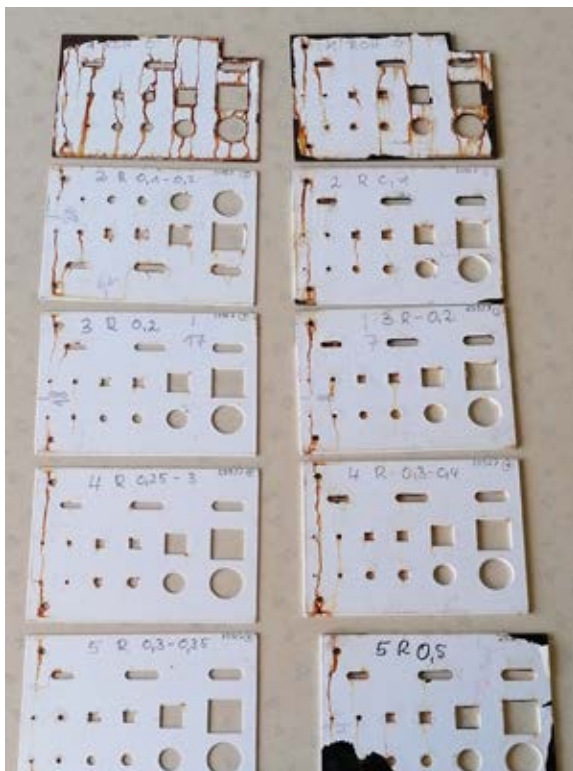
Versuch zur Kantenverrundung an lasergeschnittenen Blechen mit Sauerstoff
