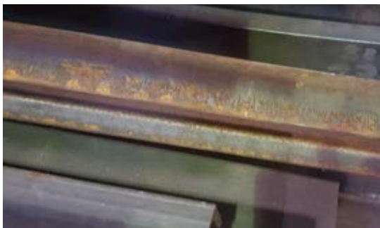
Walzzunder und Korrosion an Rohmaterialien
