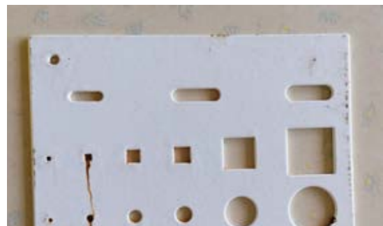
Probestück mit Kantenverrundung (0,5 mm); nach 500 h NSS lediglich kleine Korrosionserscheinungen
