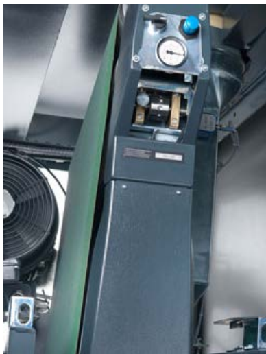
Breitbandeinheit in einer Entgrat- und Verrundungseinheit (Quelle: Karl Heesemann Maschinenfabrik GmbH)
