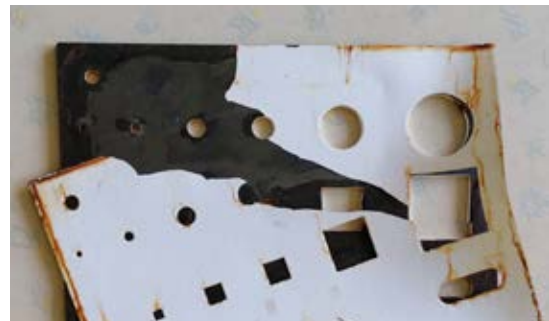
Probestück ohne Kantenverrundung; Vollenthaftung nach 250 h NSS
