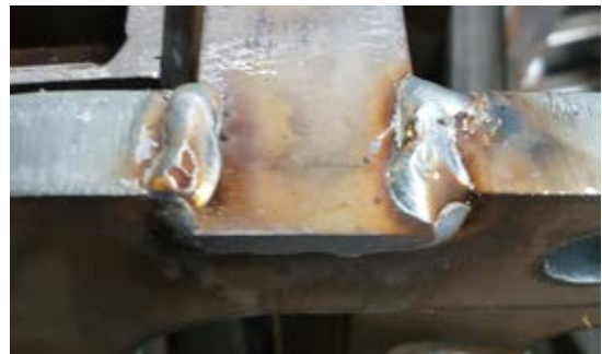
Schweißteil mit Zunder- und Fetteinbrand
