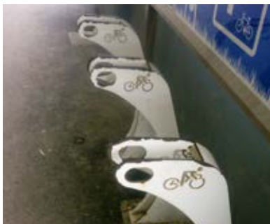
Fahrradständer mit Abplatzungen und Korrosion an der Laserkante
