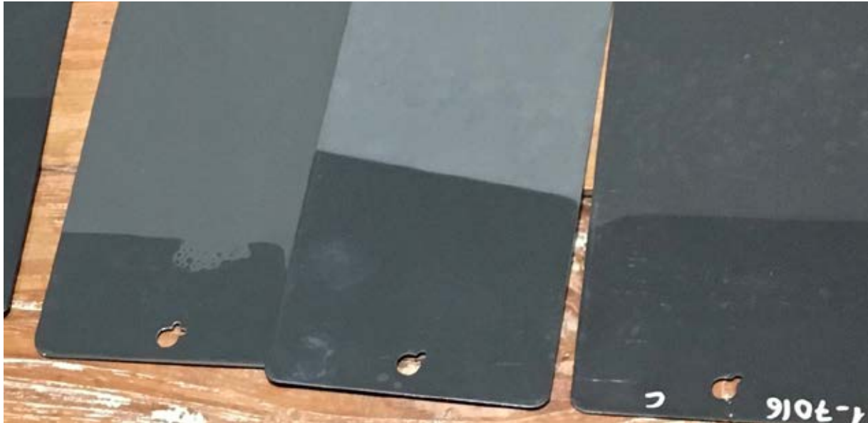
Abbildung 6: Feuchteschäden an pulverbeschichteten Aluminiumplatten: Durch die Einlagerung von Feuchtigkeit kommt es zu sichtbaren Farbveränderungen
