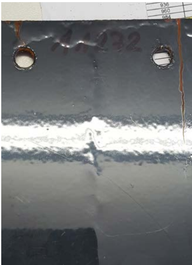
Abbildung 17: Korrosionsprobleme am Kantenbereich aufgrund nicht vorbereiteter Kanten
