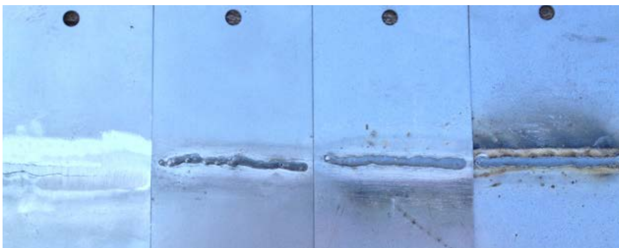
Abbildung 12: Schweißnähte in absteigendem Reinigungsgrad
