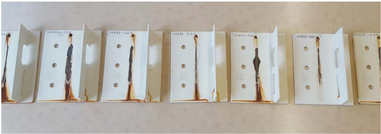
Abbildung 19: Übersicht über Ergebnisse des QIB Projektes C5 – Prüfkörper nach 1440h neutralem Salzsprühnebeltest von verschiedenen Beschichtungsbetrieben
